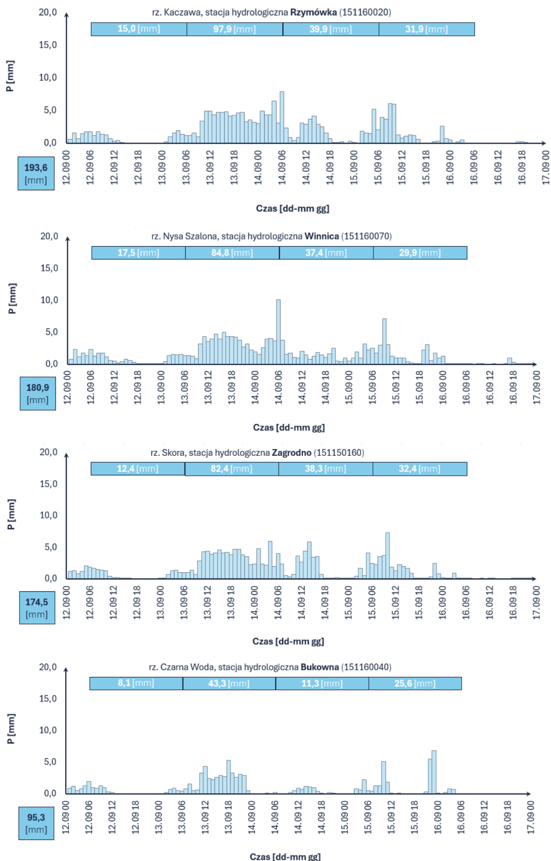
Ryc. 2.5. Hietogramy godzinowe opadów atmosferycznych w zlewniach cząstkowych Kaczawy w okresie od 12 do 16 września 2024 r. W ramkach w lewym dolnym rogu podano całkowitą sumę opadów atmosferycznych za ten okres, a w ramkach górnych sumy dobowe
